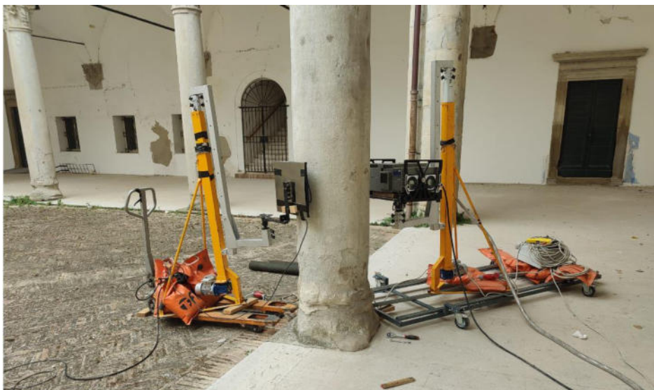
Fig. 4 – Modalità di esecuzione della prova radiografica
