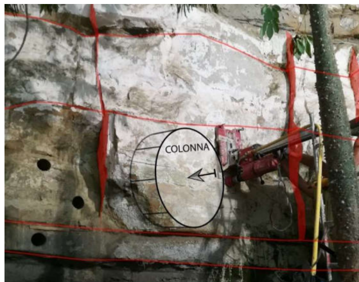
Figura 2-12 Estrazione di una colonna in affioramento tra i set di fratture e i limiti di strato.
