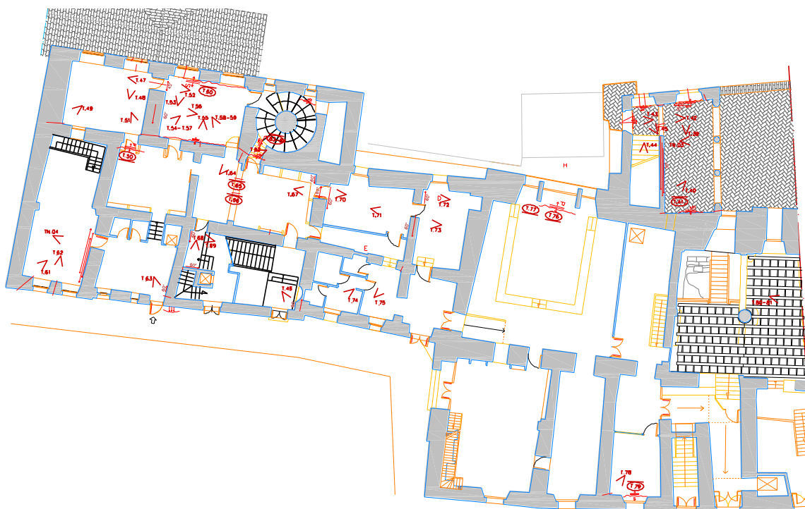
Figura 3.30 - Quadro fessurativo Piano Strada
