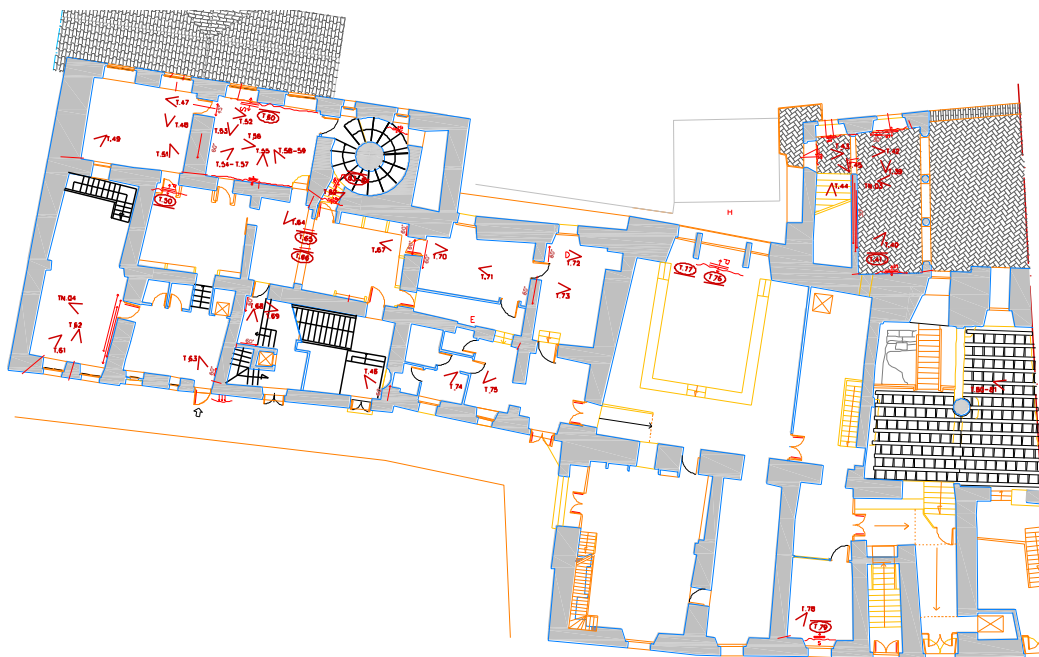
Figura 2.31 - Quadro fessurativo Piano Strada
