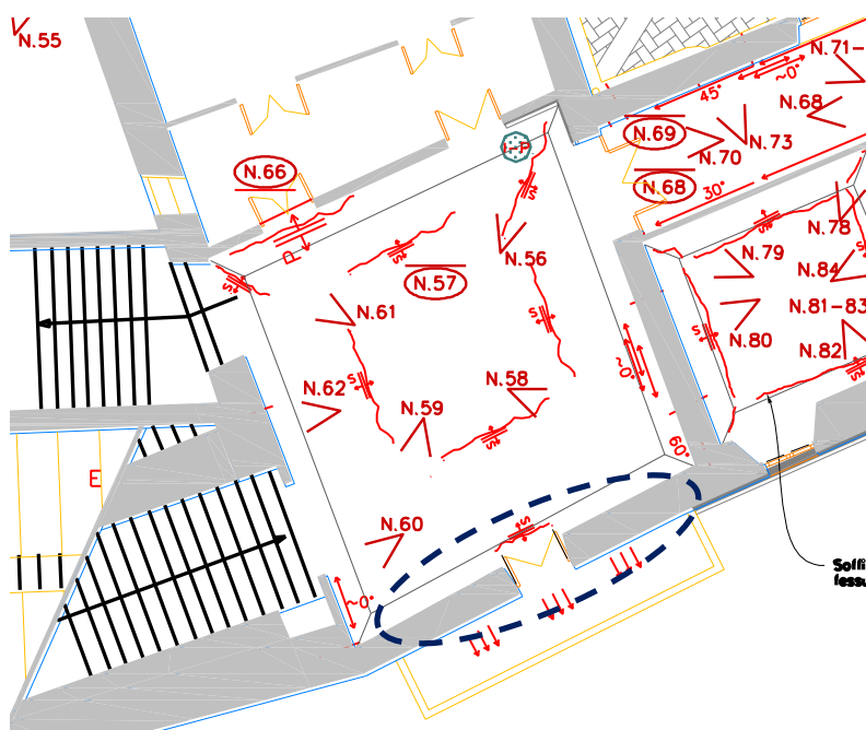
Figura 3.11 - Ubicazione della porzione di parete crollata
